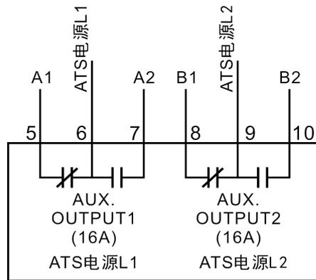
图 10 ATSS 电源线电压供电
