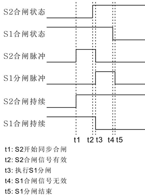
图 8 S2 同步合闸过程波形图
