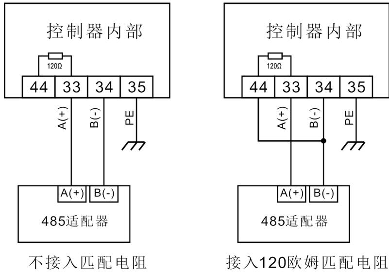
图 18 RS485 连接示意图
