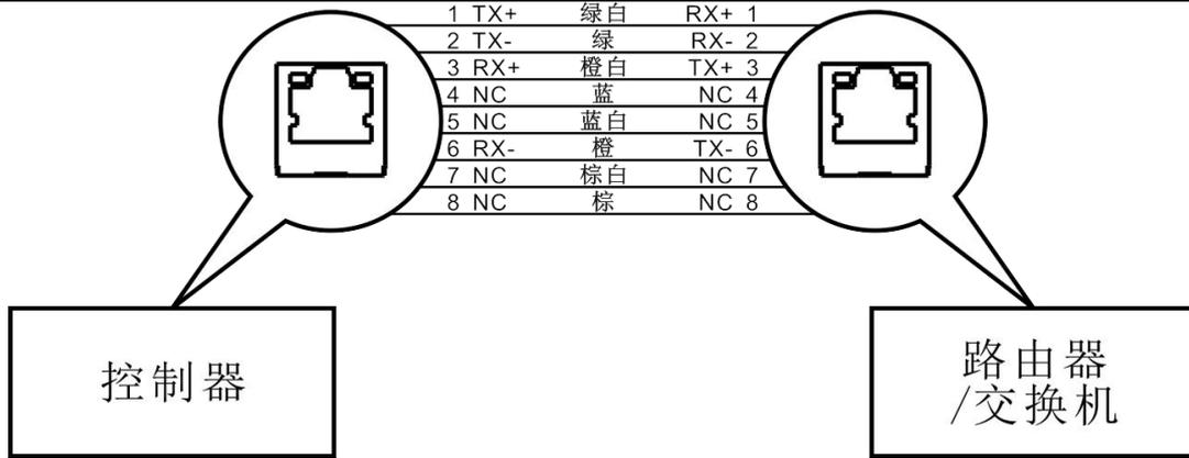
图 13 控制器与路由器直连示意图
