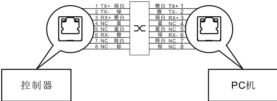
图 14 控制器与 PC 机交叉线连接示意图
