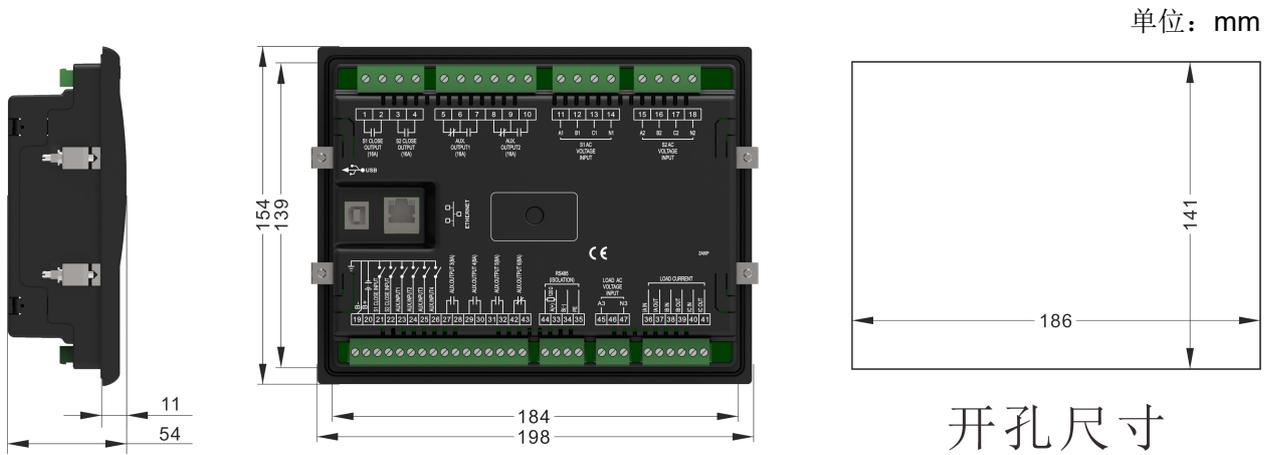
图 25 外形尺寸及面板开孔尺寸
