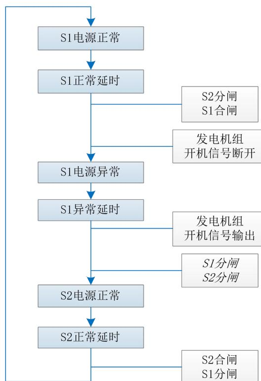
图 3 自投自复流程图
