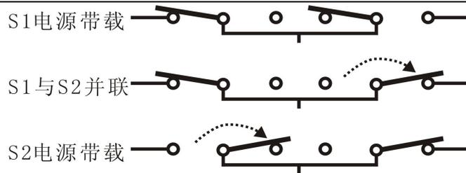
图 6 同步切换示意图
