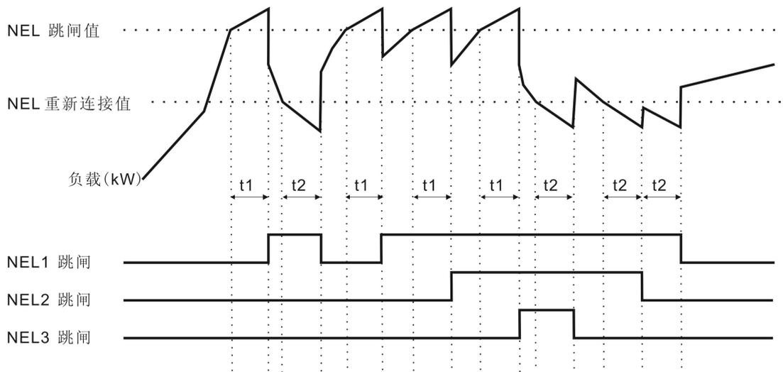
图 11 非重要负载 NEL 控制时序图
