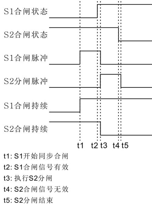
图 7 S1 同步合闸过程波形图
